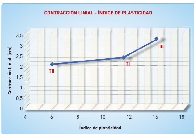
Figura 3. Contracción lineal – índice de plasticidad.
