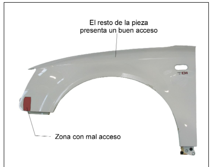
Figura 9. Accesibilidad de la aleta delantera
