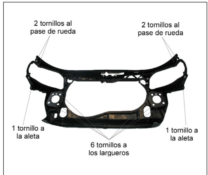
Figura 7. Unión del frente delantero
