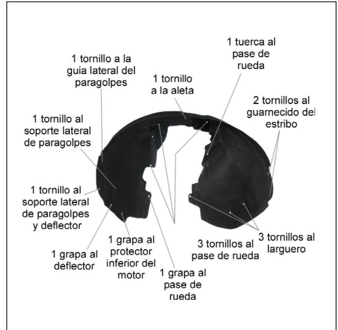
Figura 3.- Unión del guardabarros delantero
