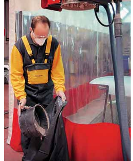
Almacenamiento de polvo de lijado
