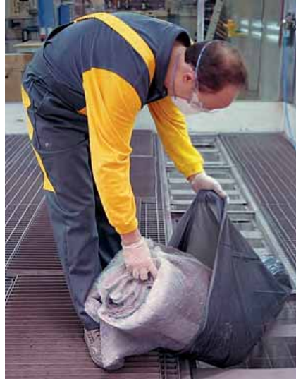
Cambio de filtros de la cabina
