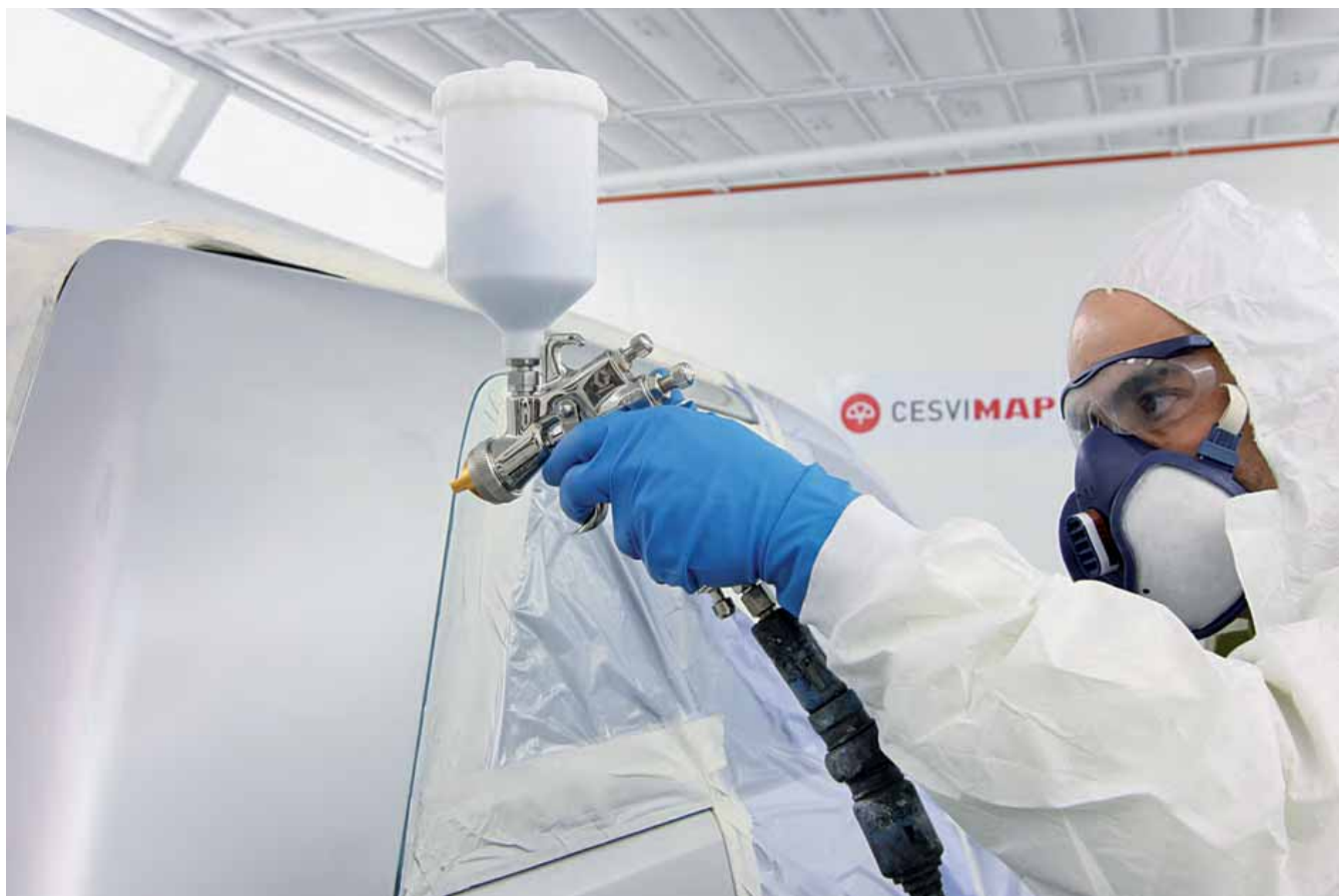
Aplicación de pintura de acabado
