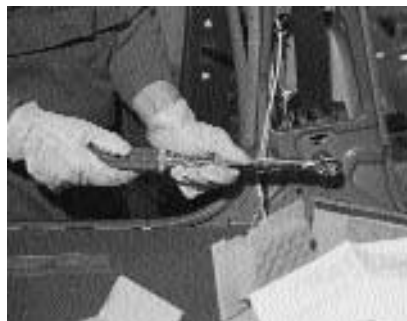
Apriete del tornillo de sujeción
