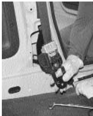
Extraer el enrollador del cinturón
