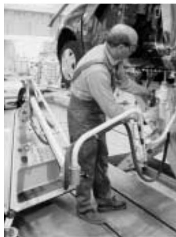
Soldadura por puntos del estribo bajo puertas
