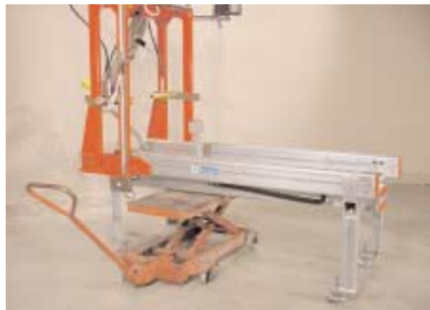
Traslado del equipo mediante mesa hidráulica
