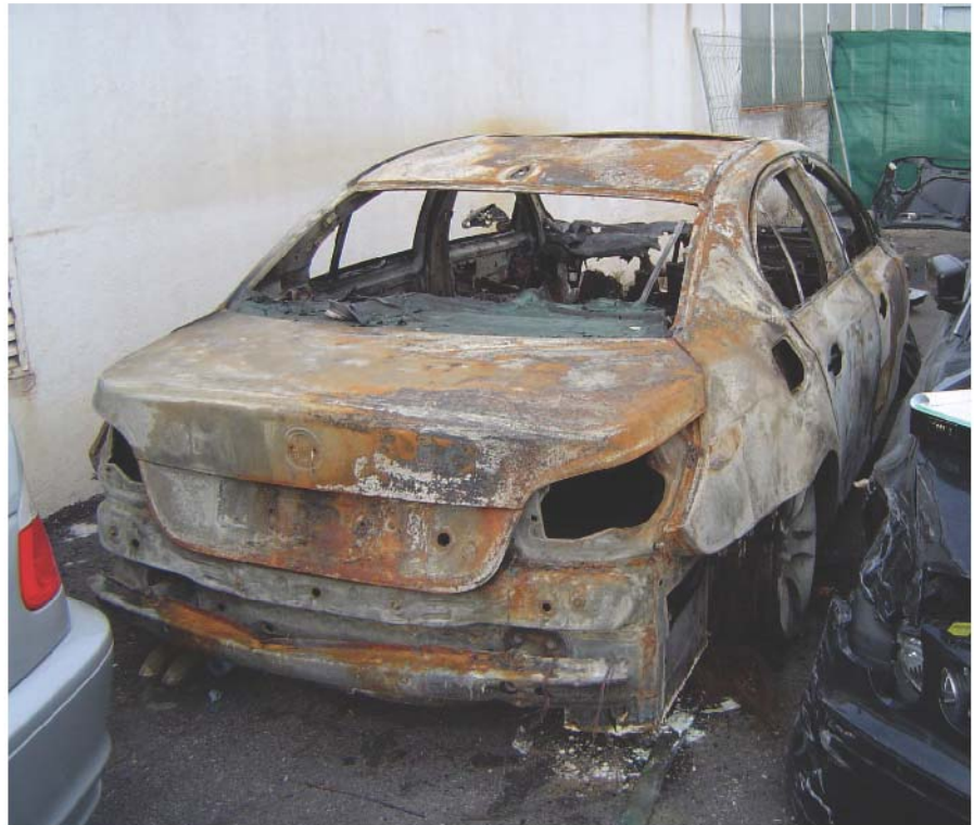
Vehículo quemado con origen en el propio vehículo.
