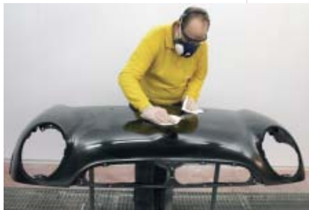
Limpieza de una pieza con cataforesis
