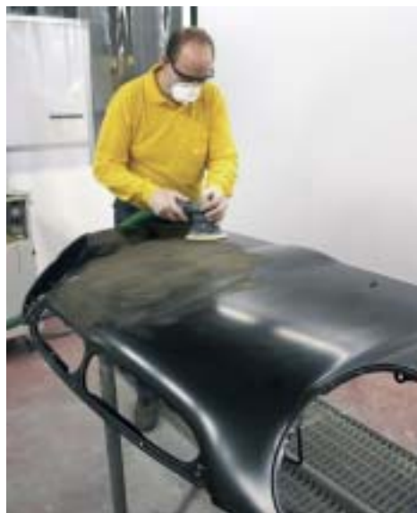
Mateado de la cataforesis con lijadora excéntrico-rotativa
