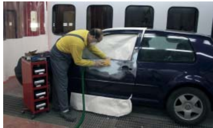
Lijado manual con taco y aspiración de polvo
