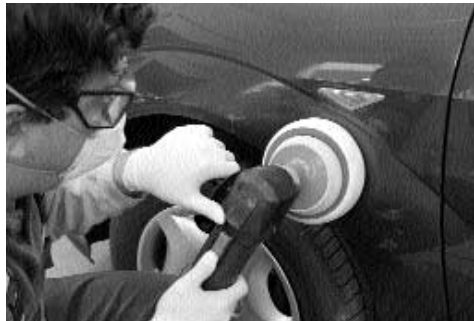
Abrillantado de la pintura
