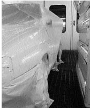
Secado completo de la pintura, antes de eliminar el defecto
