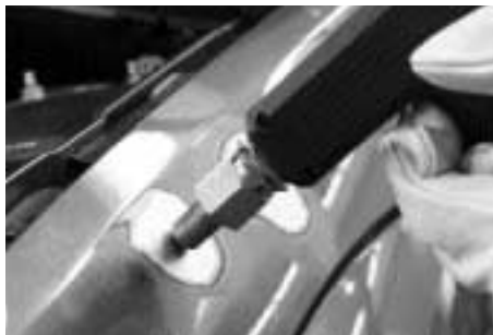
Izquierda: Reparación de una pieza de chapa
