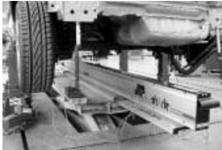
Disposición del medidor en la bancada
