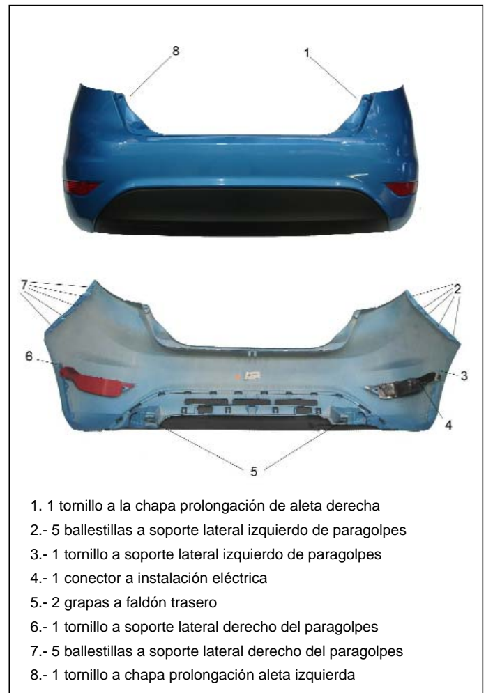
Figura 3. Unión del paragolpes trasero
