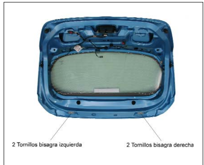
Figura 14. Unión del portón trasero
