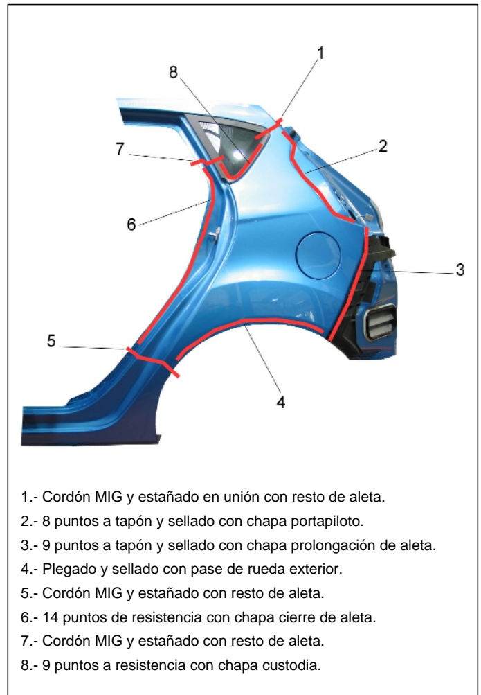
Figura 12. Unión de la aleta trasera
