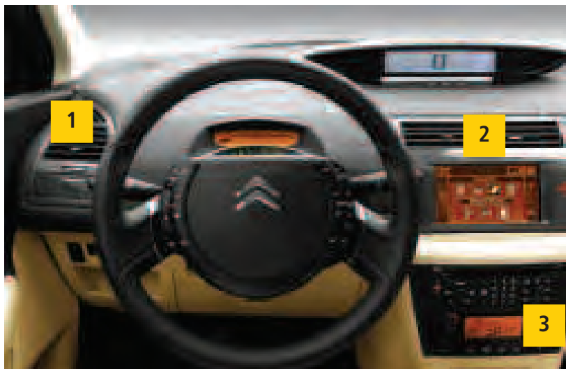
Elementos del sistema de ventilación situados en el salpicadero
