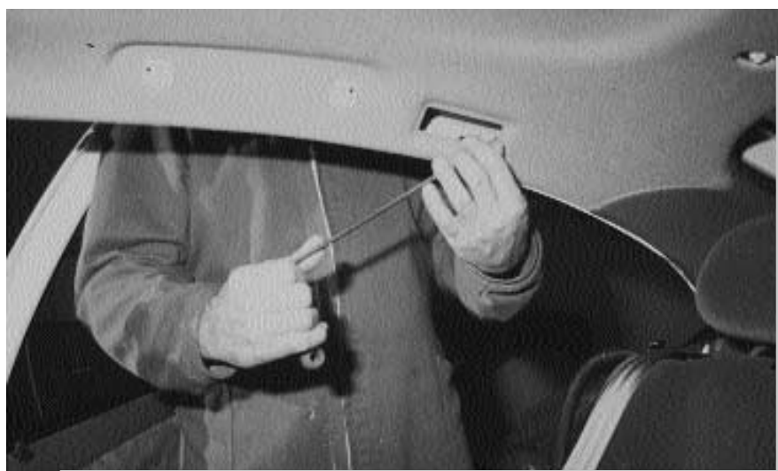
Desabonyegat mitjançant palanca.
