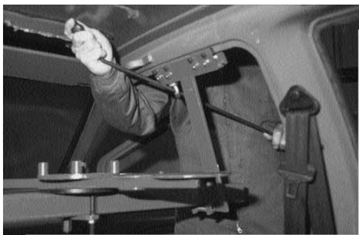
Suport de recolzament per a la reparació de sostres.
